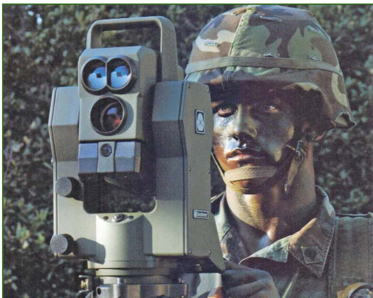
Рис. 8 Электронный тахеометр Geodimeter 400-й серии повышенной морозостойкости
