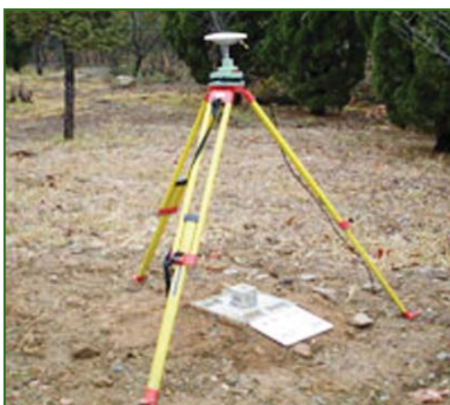
Рис. 4 Исходный пункт отсчета высот в техническом колледже Инха и типовой пункт нивелирования [5]
